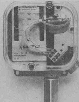
Sicherheitsregler: selbstüberwachende Fühlersysteme für Druck und Temperatur, bei «Bruch» schaltet das Gerät auf die sichere Seite. Gehäuse Schutzart IP 44 oder IP 56 nach IEC 144 bzw. DIN 40050 sowie schwadensichere Ausführung und erhöhter Korrosionsschutz (z. B. Gärkeller, Käsekeller und Tropen).
