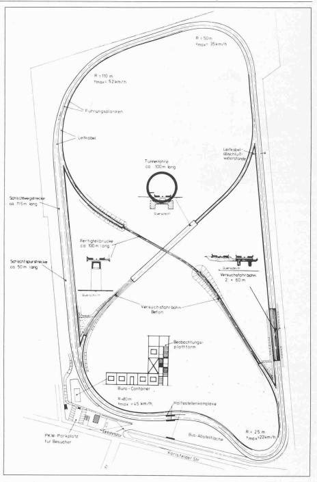
Situation der Teststrecke (Stand Juli 1979). Länge Aussenring: 1300 m. Längste Gerade: 400 m. Fahrbahn-
