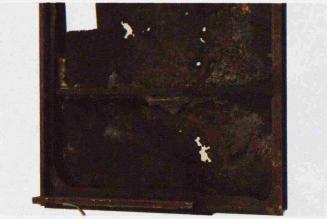
Bild 7. Aufgeschnittenes Fassadenelement mit Perforationen am Aussenblech (PUR-Schaumstoff entfernt)
