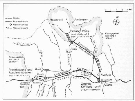
Bild 1. Übersichtskarte Kraftwerke Ilanz I und II
