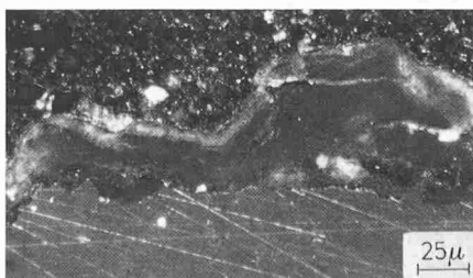
Bild 8. Querschliff durch die Rostschicht, Bewitterung 1× a) unpolarisiertes Licht (oben) b) polarisiertes Licht und gekreuzte Nicols (unten)
