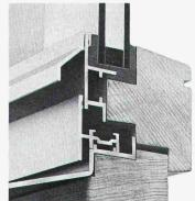
Aussen Metall, damit sie witterungsbeständig sind innen Holz, damit eine gute Isolation garantiert und eine freie Farbgebung möglich wird. Holz-Metall-Fenster von Tuchschmid - die ideale Kombination für Wohnbauten, Verwaltungs- und Industriebauten - 8500 Frauenfeld Tel. 054 7 24 71 sind preiswerte Lösungen. Holz-Metall-Fenster entsprechen den hohen Anforderungen des heutigen Energiesparen.
