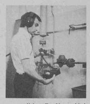
tors verglichen. Der Unterschied der beiden Signale ist ein Gemisch von Frequenzen im hörbaren Bereich, ein Geräusch also, das sich je nach den von der Sonde aufgenommenen Frequenzen ändert. Fliesst z. B. Kondensat durch einen Kondensatableiter, lässt sich ein gurgelndes Turbulenzgeräusch hören. Ein kontinuierlicher Ton mit grossem Zeigerausschlag am Steuergerät aber zeigt an, dass der Kondensatableiter «durchschlägt», also dauernd Frischdampf verliert. Zum Überprüfen einer Dampf-
