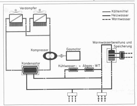
Bild 9. Anlagenschema der Standard-Gaswärmepumpenanlage
