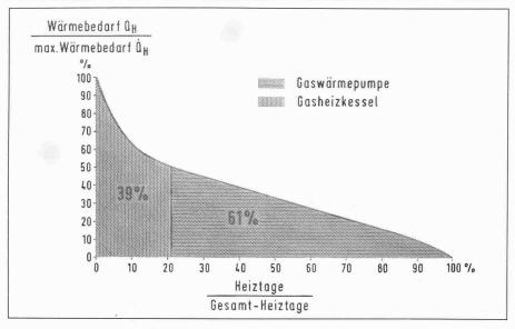
Bild 6. Gaswärmepumpe Bochum-Gerthe. Wärmebedarfsdeckung durch Gasheizkessel und Gaswärmepumpe
