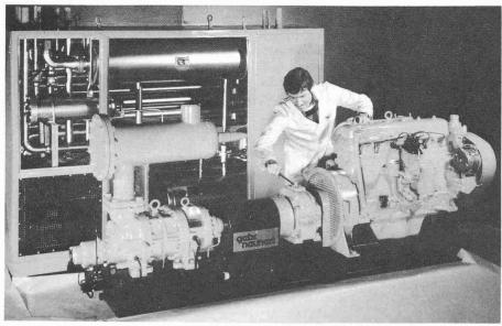
Bild 8. Standard-Gaswärmepumpenanlage
