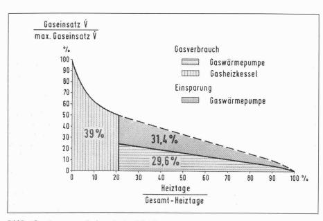
Gaswärmepumpe Bochum-Gerthe. Jährliche Energieeinsparung (Gas) durch die Gaswärmepumpe im Vergleich zu einem Gasheizkessel
