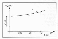
Diagramm 5. Abhängigkeit der Schalldämmung von der lichten Abhängehöhe h bei leerem Hohlraum.
