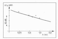
Diagramm 2. Abhängigkeit der Schalldämmung von der lichten Abhängehöhe h bei 50 mm Mineralwolle-Auflage
