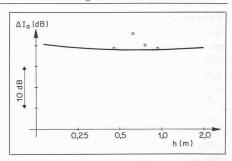
Diagramm 4. Abhängigkeit der Schalldämmung von der lichten Abhängehöhe h bei 50 mm Mineralwolle-Auflage.
