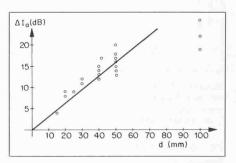
Verbesserung∆Iader Schalldämmung durch eine Mineralfaserfilz-Auflage der Dicke d bei einer Abhängehöhe von 440 mm. Dichte der Mineralwolle: 20-30 kg/m3
