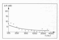
Diagramm 7. Differenz in der Schalldämmung zwischen einem offenen und einem geschlossenen Hohlraum mit 50 mm Mineralfaserfilzauflage. Abhängehöhe: 610 mm.
