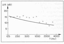
Diagramm 6. Differenz in der Schalldämmung zwischen einem offenen und einem geschlossenen Hohlraum. Deckenhohlraum ungedämpft bzw. leer. Abhängehöhe: 610 mm.
