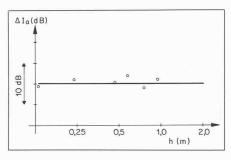
Diagramm 3. Abhängigkeit der Schalldämmung von der lichten Abhängehöhe h bei leerem Hohlraum.
