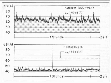
Bild 1. Pegelverlauf Autobahn und Eisenbahn in jeweils 30 m Entfernung, gleicher  $L_{\rm eq}$
