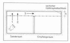
Bild 1. Darstellung der für die Schallübertragung massgebenden Komponenten
