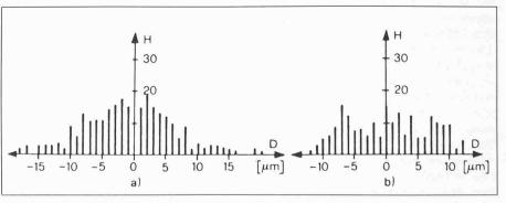
Bild 10. Histogramme unabhängiger Setzungen bei einer Feldmessung mit dem Extenso-Deflektometer-ISETH für a) Verschiebungen normal zur Bohrlochachse  $(F_x, F_y)$  b) Axialverschiebungen (1) (H: Häufigkeit der Setzungen, D: Abweichung vom Mittelwert)
