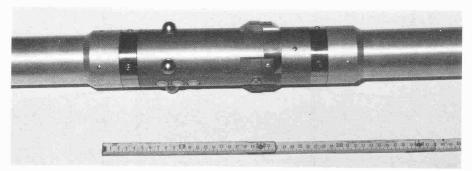
Bild 15. Mittlerer Kopf des Extenso-Deflektometers-ISETH
