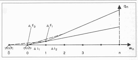
Bild 7. Bestimmung der Verschiebung q<sub>n</sub> normal zur Bohrlochachse
