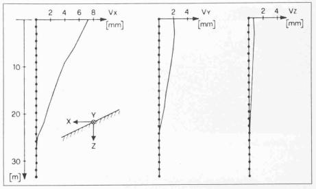
Bild 11. Gemessene räumliche Verschiebungen in einem Kriechgang (Lehnenviadukt Beckenried)
