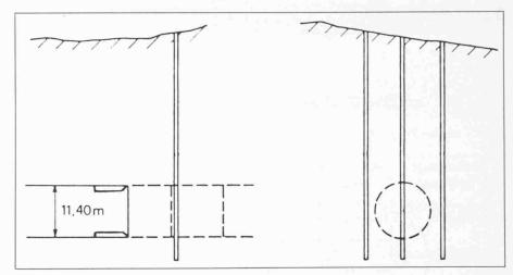
Bild 12. Anordnung der Bohrlöcher zur Beobachtung der als Folge des Tunnelvortriebes im Baugrund entstehenden Verschiebungen (Hagenholztunnel)
