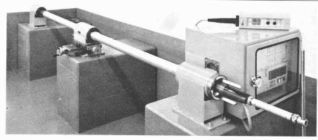
Bild 14. Extenso-Deflektometer-ISETH in der Eichbank mit zugehöriger elektronischer Datenerfassungsanlage
