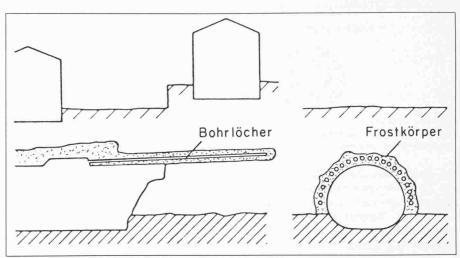
Bild 13. Gefrierverfahren. Messung der Initialabweichung der Bohrlöcher (Milchbucktunnel)
