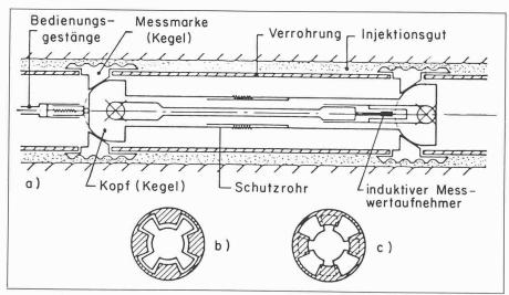
Bild 16. Gleitmikrometer-ISETH
