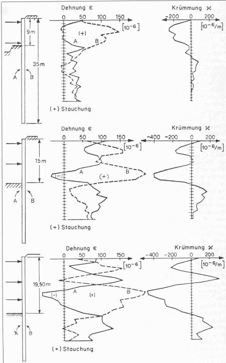
U-Bahn Sao Paulo: Resultate der Messungen mit dem Gleitmikrometer-ISETH in einem Querschnitt der Schlitzwand für drei Aushubphasen
