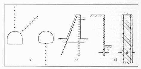
Bild 19. Anwendungsmöglichkeiten für das Gleitmikrometer-ISETH
