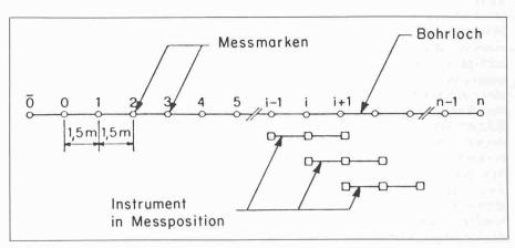
Bild 2. Messprinzip: Definition von Instrumentenpositionen mit Hilfe von Messmarken entlang des Bohrloches
