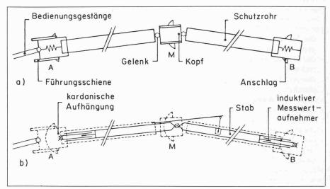
Bild 5. Schematische Darstellung des Extenso-Deflektometers-ISETH:
