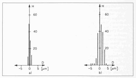
Bild 18. Histogramme unabhängiger Setzungen a) in der Eichlehre b) Feldmessung (H: Häufigkeit der Setzungen, D: Abweichung vom Mittelwert)
