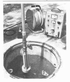
Bild 20. Gleitmikrometer-ISETH, Einführen der Messonde in ein Bohrloch
