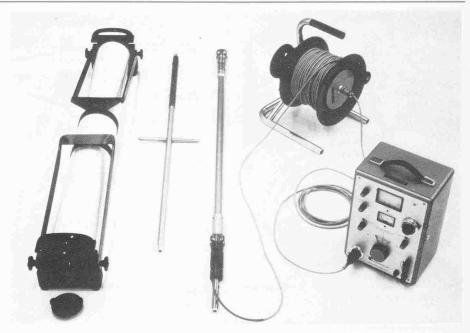
Bild 17. Das Gleitmikrometer-ISETH mit Eichlehre, Bedienungsgestänge, Messonde und Ableseeinheit
