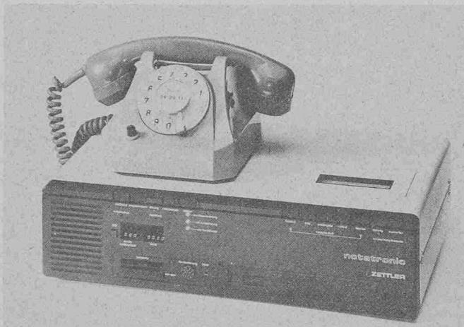
Die Dauer der Aufzeichnung wird durch die Sprache des Anrufers bestimmt. Auch innerhalb einer vom Besitzer evtl. eingestellten Fixzeit von 360, 180, 120, 60 oder 30 Sekunden bleibt das Gerät nur so lange auf Aufnahme geschaltet, wie der Anrufer spricht. Während grösseren Betriebspausen kann das Gerät auf Nurbeantworter ohne Gesprächsaufzeichnung geschaltet werden.
