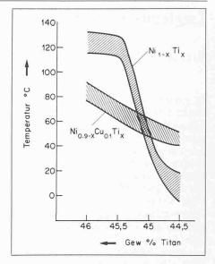
Bild 3. Zusammensetzungsabhängigkeit des kritischen Temperaturbereiches beim Aufheizen für Nikkel-Titan und Nickel-Kupfer-Titan
