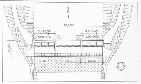
Bild 9. Lageplan des fertigen Wehres
