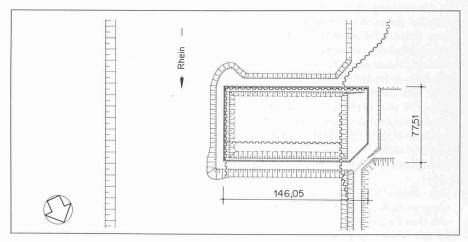
Bild 1. Lageplan mit Baugrube, 1. Bauabschnitt
