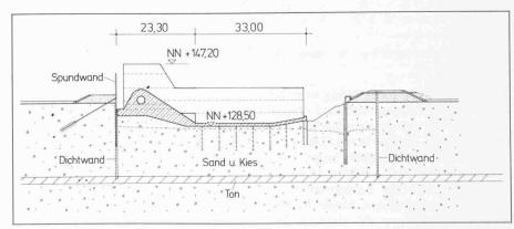
Bild 5. Schnitt durch den mittleren Teil des Wehres mit fester Wehrschwelle
