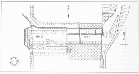
Bild 2. Lageplan mit Baugrube, 2. Bauabschnitt
