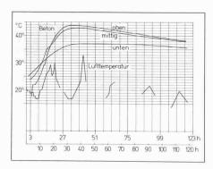
Bild 7. Temperaturentwicklung im Beton der Wehrsohle
