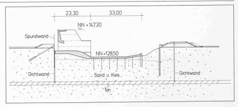
Bild 3. Schnitt durch das Staubalkenwehr
