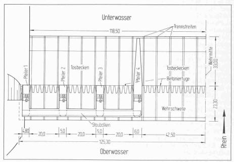
Bild 7. Unterteilung in 6 bis 8 m breite Betonierstreifen mit jeweils 1 m breiten Fugenzwischenräumen
