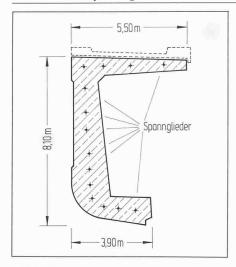
Bild 5. Querschnitt des Staubbalkens
