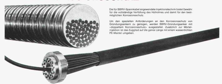
Der Ingenieur fordert die dauerhafte Erhaltung der in das Bauwerk eingetragenen Spannkräfte. Deshalb ist vor allem der Korrosionsschutz der Spannkabel sicherzustellen. Die Verantwortung hie für trägt praktisch ausschliesslich der Spannkabelhersteller. Seine Bemühungen beziehen sich auf die Wahl des Spannstahles, auf die Beachtung des Korrosionsschutzes bei der konstruktiven Auslegung des Spannkabels in allen Details und auf die abschliessende Injektion des eingebauten Spannkabels.
