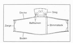
Bild 3. Schnitt durch eine Violine
