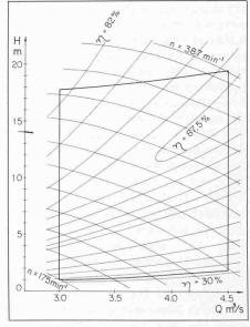
Bild 10. Charakteristiken der Zubringerpumpen
