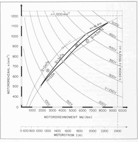
Bild 13. Charakteristiken von Motor und Zubringerpumpe
