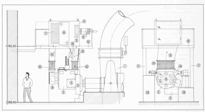
Bild 11. Zubringerpumpengruppe mit Fremdbelüftung- und Kühlaggregat
