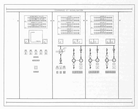
Bild. 17. Steuer- und Überwachungsteil der Direktsteuertafel
