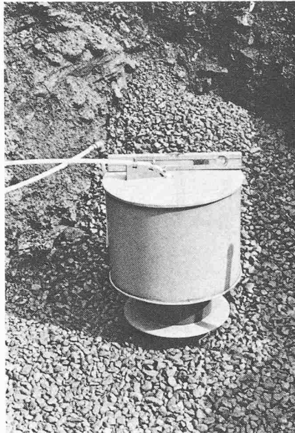
Bild 7. Setzungsmessgerät Typ LEGEP. Mit dem Dammfundament verbundene Zelle
