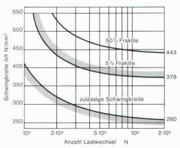
Dieses Diagramm zeigt oben die Wöhlerkurve für den Einzeldraht Ø 7 mm, wie er für das Spannverfahren BBRV verwendet wird. Aufgezeichnet sind die Kurven für die 5% resp. 50% Fraktile, d.h. 95% resp. 50% des Drahtmaterials überschreitet die entsprechenden Werte. Die untere Kurve zeigt die zulässige Schwingbreite  $\Delta\sigma$  für Spannkabel mit BBRV-DINA Verankerungen.
