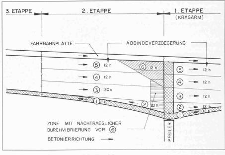
Betoniervorgang Brückentrog im Bereich des Flusspfeilers
