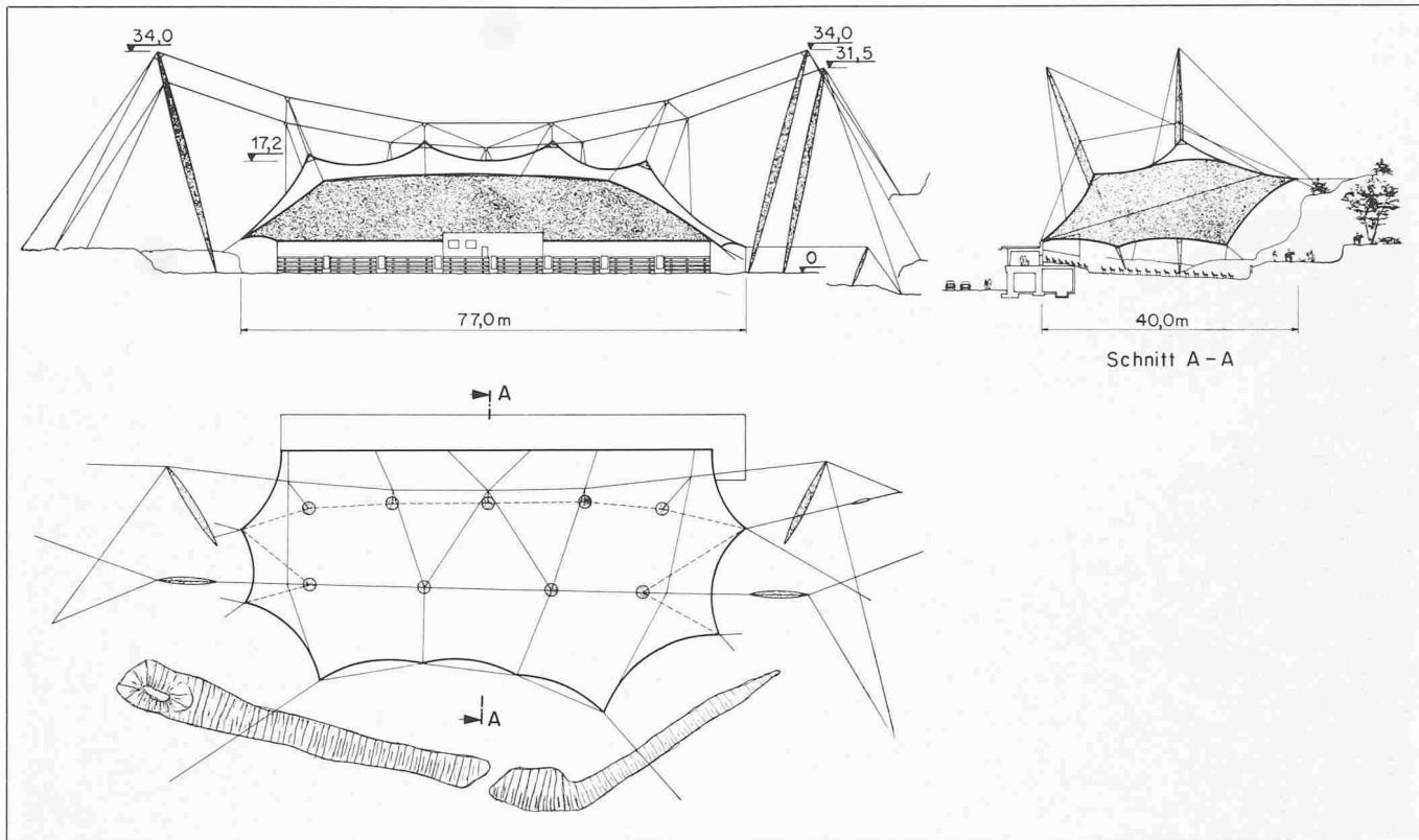
steten Zonen, wie z. B. den Hochpunkten, in den Gratseilbereichen und an den Rändern, verstärkte man die Membran mit ein oder zwei weiteren Materiallagen. Die Zuschnitte
