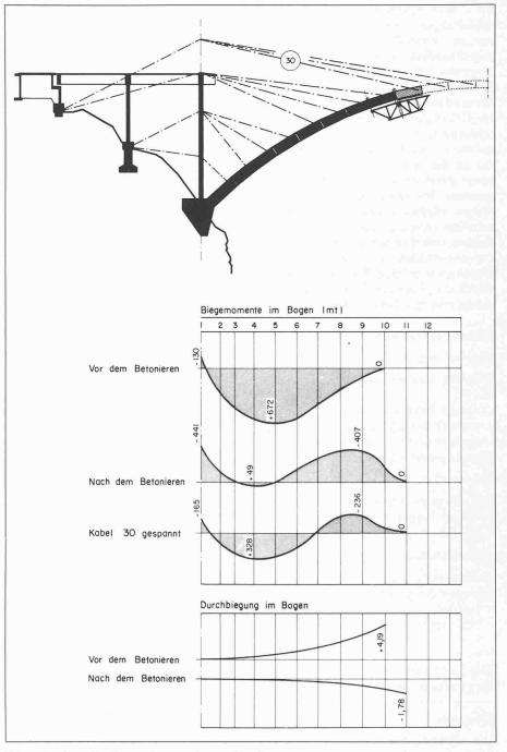
Schema 3. Statisches System, Beanspruchung und Verformung
