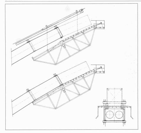
Schema 4. Ablauf des Verschiebevorganges Oben: Verschieben des Vorbauwagens Unten links: Vorbaugerüst in Betonierstellung
