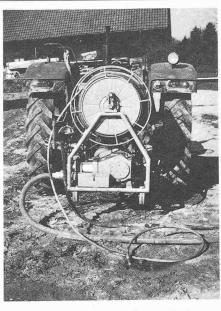
Bild 2. Angebautes Dränspülgerät «Fricke» am Dreipunktgestänge des Traktors
