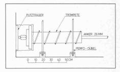
Bild 7. Detail des Ankerkopfes
