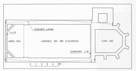
Bild 13. Verlauf der Spannglieder unter dem Gesimse
