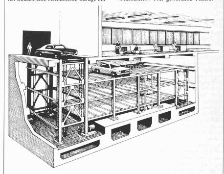
vier Parkebenen für 46 Einstellplätze im Keller eines fünfgeschossigen Verwaltungsgebäudes montiert. Der Kellerraum hat 28 m Länge, 6 m Breite und 8 m Höhe, was einem umbauten Raum von 1344 m<sup>3</sup> entspricht. 46 Pkws parken auf einer Grundfläche von nur 168 m². Diese Garage nach dem Horizontalsystem «Krupp-Park» in mehreren Ebenen von Krupp Industrie- und Stahlbau, Duisburg-Rheinhausen, schafft also Parkplätze auf kleinster Grundfläche.
