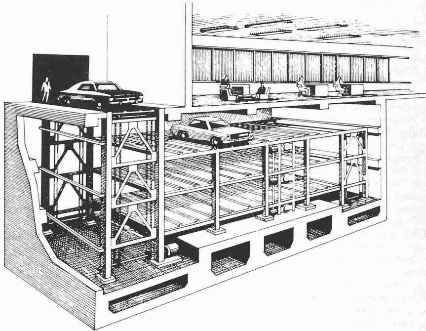
*vier Parkebenen für 46 Einstellplätze im Keller eines fünfgeschossigen Verwaltungsgebäudes montiert. Der Kellerraum hat 28 m Länge, 6 m Breite und 8 m Höhe, was einem umbauten Raum von 1344 m³ entspricht. 46 Pkws parken auf einer Grundfläche von nur 168 m². Diese Garage nach dem Horizontalsystem «Krupp-Park» in mehreren Ebenen von Krupp Industrie- und Stahlbau, Duisburg-Rheinhausen, schafft also Parkplätze auf kleinstem Raum.*
