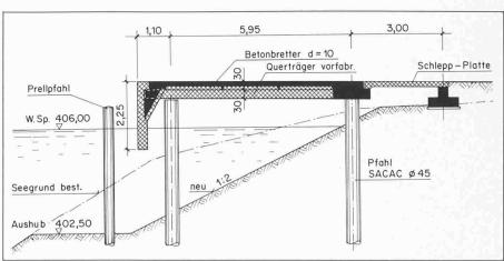
Bild 4. Querschnitt durch Ufermauer-Konstruktion
