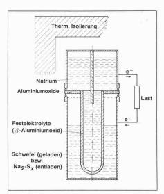
Bild 1. Schema einer Na/S-Zelle; Betriebstemperatur ca. 300°C
