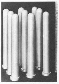
Rild 2 Beta-Aluminiumoxid-Rohre fertig Einbau in Na/S-Zellen
