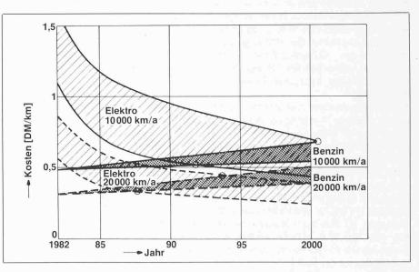
Bild 9. Erwartete Kosten je km für Elektrotransporter mit Na/S-Batterie und für konventionelle Transporter bei Fahrleistungen von 10 000 bzw. 20 000 km je Jahr
