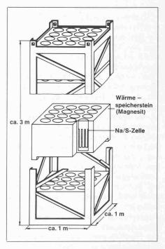
224 kWh-Modul aus 80 Na/S-Zellen. Gewicht der Zellen 1100 kg; mit Speichersteinen ca. 5000 kg. Der Modul kann z. B. mit einem Kran transportiert werden
