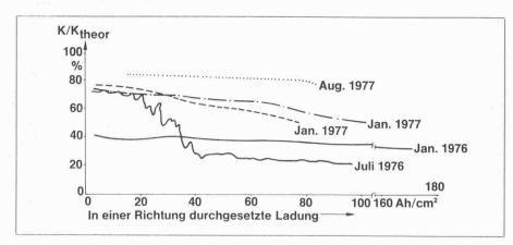
Bild 3. Relative Kapazität K/Ktheor, von Na/S-Versuchszellen als Funktion der in einer Richtung pro cm<sup>2</sup> durchgesetzten Ladung K = gemessene Kapazität,  $K_{theor.}$  = Kapazität, die einer Stöchiometrieänderung im Schwefelraum von reinem Schwefel bis Na2S3 entspricht
