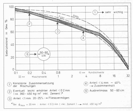
Bild 3. Kriterien für die Zusammensetzung des Zuschlagmaterials für Fliessbeton
