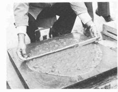
Bild 5. Ausbreitmass des Fliessbetons (1,4% Superverflüssiger) = 55 cm
