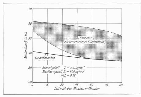
Bild 9. Ausbreitmass von Fliessbeton mit verschiedenen Fliessmitteln in Abhängigkeit von der Zeit nach dem Zumischen des Superverflüssigers (nach [4])
