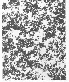
Bild 1. Agglomerate eines Portlandzementes «normal» in der ersten Hydratationsphase, ohne Zusatzmittel (Photo [3])
