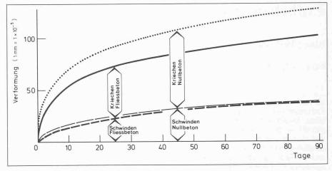
Bild 13. Vergleichende Messungen der Schwind- und Kriechverformungen an Null- bzw. Fliessbeton (gleiche Konsistenz, verschiedene W/Z-Faktoren, gleicher Zementgehalt). Belastungsbeginn nach zehn Tagen. p =
