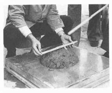
Bild 4. Messung des Ausbreitmasses am Ausgangsbeton (Ausbreitmass = 34 cm)
