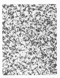
Bild 2. Portlandzement-Suspension mit demselben W/Z-Faktor wie in Bild 1 bei gleicher Vergrösserung, aber nach Zugabe von Superverflüssiger. Man beachte die feinere und gleichmässigere Dispersion der Teilchen (Photo [3])
