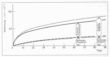
Bild 14. Vergleichende Messungen der Schwind- und Kriechverformungen an Null- bzw. Fliessbeton (gleiche Konsistenz, verschiedene W/Z-Faktoren, gleicher Zementgehalt). Belastungsbeginn nach drei Tagen. p = 10 N/mm2 (nach [12])
