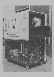
mose-Schrankgerät entwickelt. In der Normalausführung erzeugt es stündlich je nach Modulbestückung 0,3 bis 0,8 m³ Reinwasser. Mit Spezialausrüstung lässt sich die Kapazität auf 1,2 m³/h erhöhen. Das Rohwasser kann einen Salzgehalt von 2000 mg/l haben. Der Restsalzgehalt nach der Behandlung beträgt maximal 10 Prozent.
