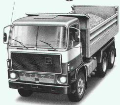
Volvo CH 250: Gesamtgewichl 25 resp. 281. Radstand nach Wunsch, 2,5 m breit, Ganzstahl-Sicherheitskippkabine mit Ruhebeit oder Kurzkabine, Volvo-Dieselmotor mit 506 DIN/PS netto mit Abgasturboilder, 16-Gang-Getriebe oder auf Wunsch mit Automat.
