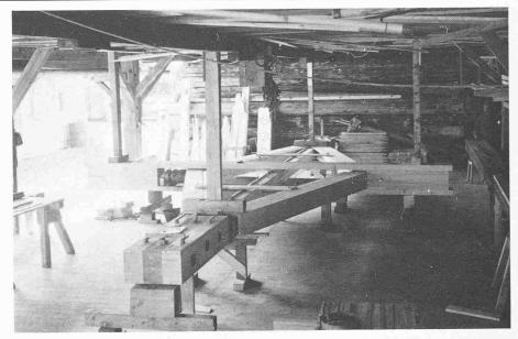
Bild 12. Versuche über die Festigkeit verschiedenartiger Lamellenstösse in geleimten Holzzugbändern, durchgeführt bei Geiger & Co. in Bern, 1947, in Zusammenarbeit mit der EMPA. (Foto EMPA-Holz)
