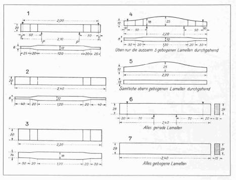
Bild 11. Durch F. Hübner an der EMPA Zürich untersuchte Typen verleimter Biegebalken, 1919[7]
