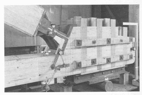
Bild 13. Versuche an der EMPA über die Festigkeit sehr grosser Scherflächen, in Zusammenhang mit dem Bau der Mustermessehalle VIII in Basel, 1941. (Foto EMPA-Holz) [22]
