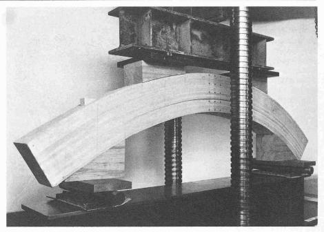
Bild 15. Versuche über die Auswirkung der bei Biegung in geleimten Bögen auftretenden Querzugspannungen, EMPA 1947. (Foto EMPA-Holz)
