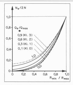
Bild 6. Wirksame Spannungswechselzahl  $N_e$  in Abhängigkeit von  $R_{min}/R_{max}$  und dem Belastungszustand  $(Q_e/Q_{max})$  nach Tabelle 1
