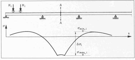
Bild 1. Spannungsverlauf im Querschnitt A-A bei der Überfahrt der Radlasten R, über den Kranbahnträger
