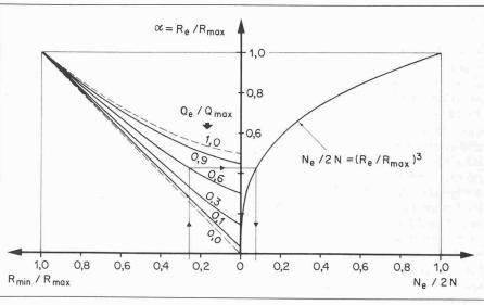
Bild 5. Zusammenhang zwischen  $R_{min}/R_{max}$ ,  $R_e/R_{max}$  und  $N_e/2N$  in Funktion von  $Q_e/Q_{max}$
