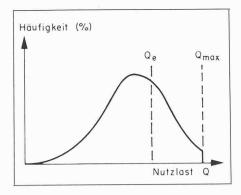
Bild 2. Schematische Häufigkeitsverteilung der Nutzlast Q
