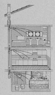
stelle mit höherer Luftgeschwindigkeit, die sich bei der Erweiterung auf den Führungsrohrquerschnitt entsprechend verringert. Da das System keine Querschnittserweiterungen aufweist, erhöht sich die Volumenge-schwindigkeit von Geschoss zu Geschoss.
