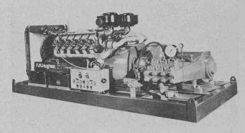
Selbstständige Geräteeinheit zum Antreiben der Pumpe Spritzpistole mit Verlängerungsaufsatz
