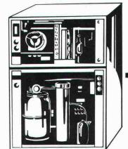
Energiesparen im Hallenbad: ELCO Klimablock mit Wärmepumpe.
