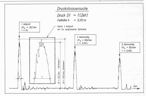
Bild 3. Druckstoss-Verlauf
