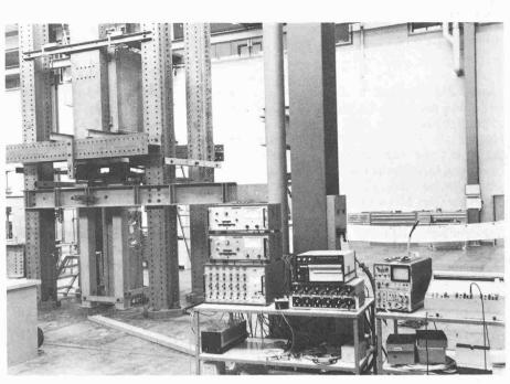
Bild 2. Versuchseinrichtung mit Prüfstand rechts hinten und Messapparatur links vorne im Bild
