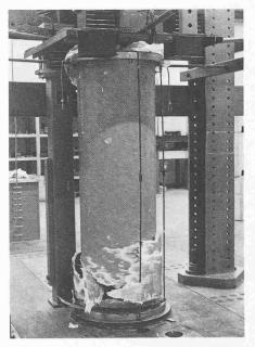
Bild 4. GFK-Schleuderrohr Ø 600 mm nach mehreren Vorversuchen bei einem Innendruck von 97 bar geplatzt. Maximale Umfangsdehnung in Rohrmitte ε = 1.3%.
