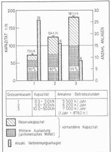
Bild 6. Anzahl Anlagen, Kapazität und Auslastung der kommunalen Abfallverbrennungsanlagen in Betrieb nach Grössenklassen, Stand 1. Januar
