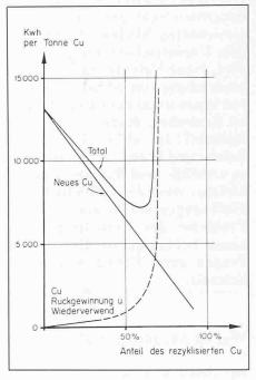
Bild 2. Energieaufwand für die Herstellung einer Tonne Kupfer in Abhängigkeit des prozentualen Anteils an rezirkuliertem Kupfer (Stumm und Davis 1974, [6])
