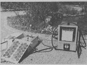
Ein solches Solarelement genügt, um die Batterie des tragbaren Arkon-Pegelstand-Registriergerätes dauernd aufzuladen; rechts: Mess- und Registriergerät, links hinter dem Solarelement: Luftversorgungseinheit mit Batterie und Luftpumpe – zur Verdeutlichung geöffnet
