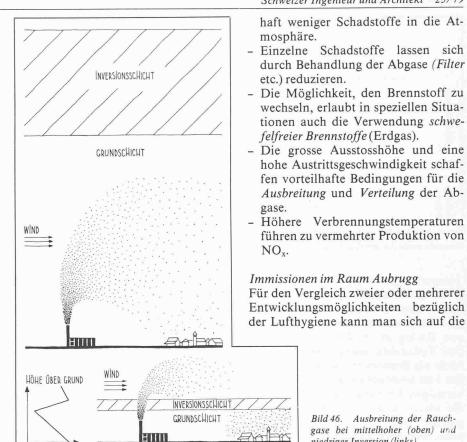
Bild 46. Ausbreitung der Rauchgase bei mittelhoher (oben) und
