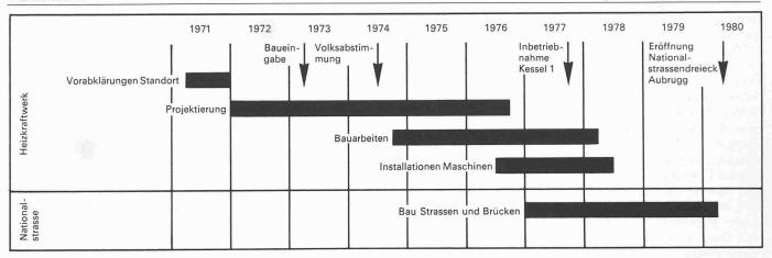
Terminkalender für den Bau des Heizkraftwerkes und der Nationalstrassen
