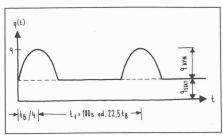
Bild 39. Verlauf des Staudruckes nach Schlaich [2]
