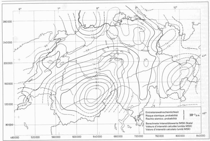
Bild 42. Intensitätskarte für das seismische Risiko in der Schweiz bei einer Eintretenswahrscheinlichkeit von 10<sup>-3</sup> pro Jahr
