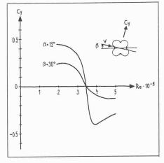
Bild 38. Am Modell im Windkanal gemessene Seitenkraftbeiwerte  $C_v$
