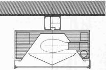
Bild 27. Beleuchtungskörper und Tragprofil der Natriumhochdruck-Leuchte
