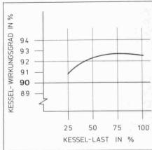
Bild 10. Kesselwirkungsgrad eines Mitteldruckkessels
