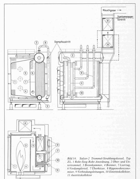
axial in Richtung der drei übereinander angeordneten Brenner (4). Seitlich an die Brennkammer schliesst ein Leerzug (5) an und daneben der Verdampferteil mit der Konvektionsheizfläche (6). Im Verdampferzug ist auch der Überhitzer (7) eingebaut. Er besteht aus einfachen horizontalen U-Rohrschlangen, die in die aussenliegenden Kollektoren eingeschweisst sind. Über dem Kessel liegt ein Rippenrohreconomiser (8), der aus zwei Bündeln besteht.
