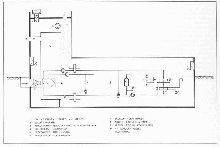
Bild 20. Prinzipschema der Kühl- und zentralen Lüftungsanlage
