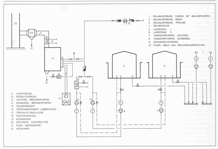
Bild 19. Brennstoffversorgung, Brennluft und Rauchgasschema
