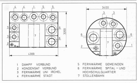
Bild 18. Links Kanalquerschnitt zwischen Heizkraftwerk und KVA II, rechts Stollenquerschnitt im bergmännisch vorgetriebenen Teil
