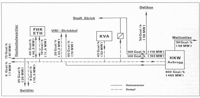
Bild 3. Wärmeverteilschema des HKW Abrugg
