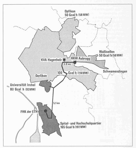
Bild 2. Wärmeversorgungsgebiet des Heizkraftwerks Aubrugg
