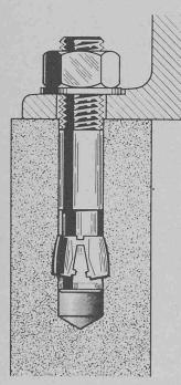
Verankerung eines Maschinensockels mit Porabolt-Ankerbolzen
