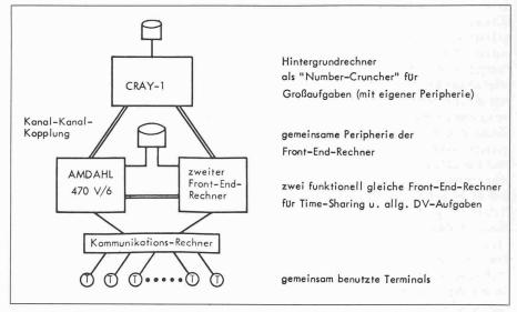
Angestrebtes Tandem-Konzept für die Grossenrechenanlage im Max-Planck-Institut für Plasmaphysik in Garching
