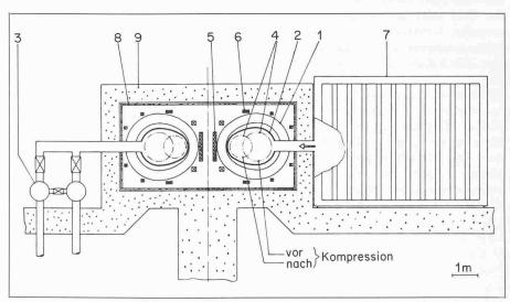
Querschnitt durch den Entwurf für die Experimentieranordnung Zephyr. 1 Hauptfeldspule, 2 Vakuumgefäss mit Hitzeschild, 3 Vakuumpumpen, 4 Plasma, 5 Transformatorspule, 6 Gleichgewichtsspulen, 7 Neutralstrahl-Injektor, 8 Kühlbox, 9 Innere Beton-Abschirmwand
