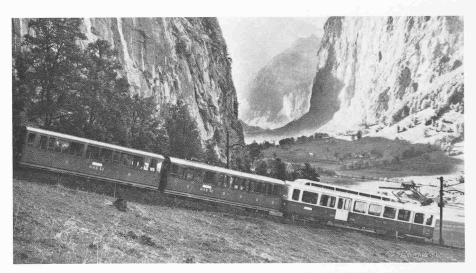
Bild 1. Zug der Wengernalpbahn mit elektrischem Zahnrad-Triebwagen ABDhe 4/4 und Vorstellwagen
