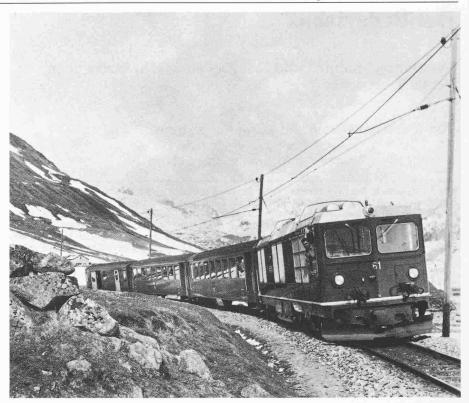
Bild 11. Zug der Furka-Oberalp-Bahn mit dieselelektrischer Lokomotive HGm 4/4.
