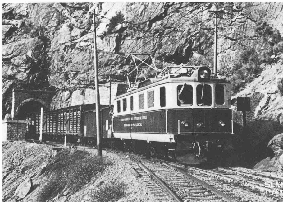
Bild 10. Güterzug der Transandino-Bahn in Chile mit elektrischer Zahnrad-Lokomotive HGE 4/4
