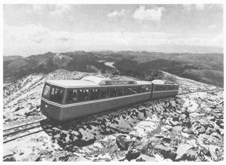
Dieselhydraulischer Zahnrad-Doppeltriebwagen Bhm 4/8 der Manitou and Pike's Peak Railway, Colorado, USA
