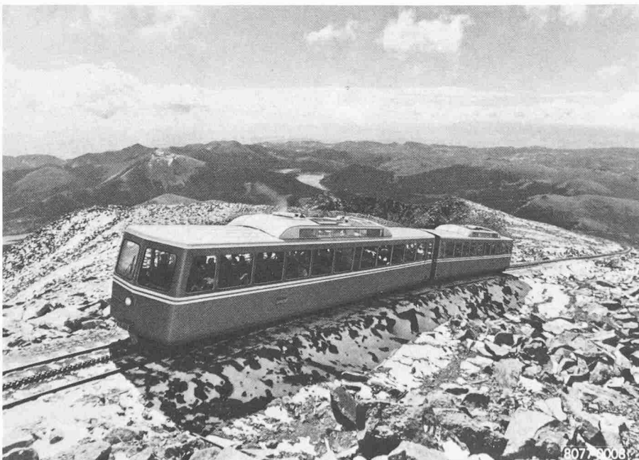
Bild 5. Dieselhydraulischer Zahnrad-Doppeltriebwagen Bhm 4/8 der Manitou and Pike's Peak Railway, Colorado, USA
