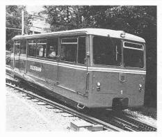
Bild 6. Elektrischer Zahnrad-Triebwagen der Dolderbahn in Zürich
