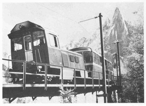
Bild 2. Dieselhydraulische Zahnrad- und Abhäsionslokomotive mit Vorstellwagen der Chamonix-Montenvers-Bahn
