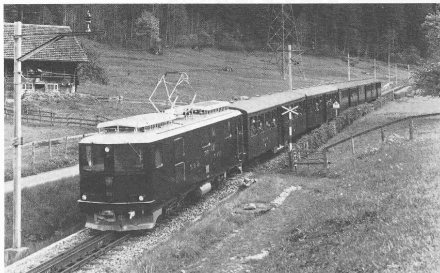
Bild 8. Zug der Brünigbahn mit elektrischer Zahnrad-Lokomotive HGe 4/4
