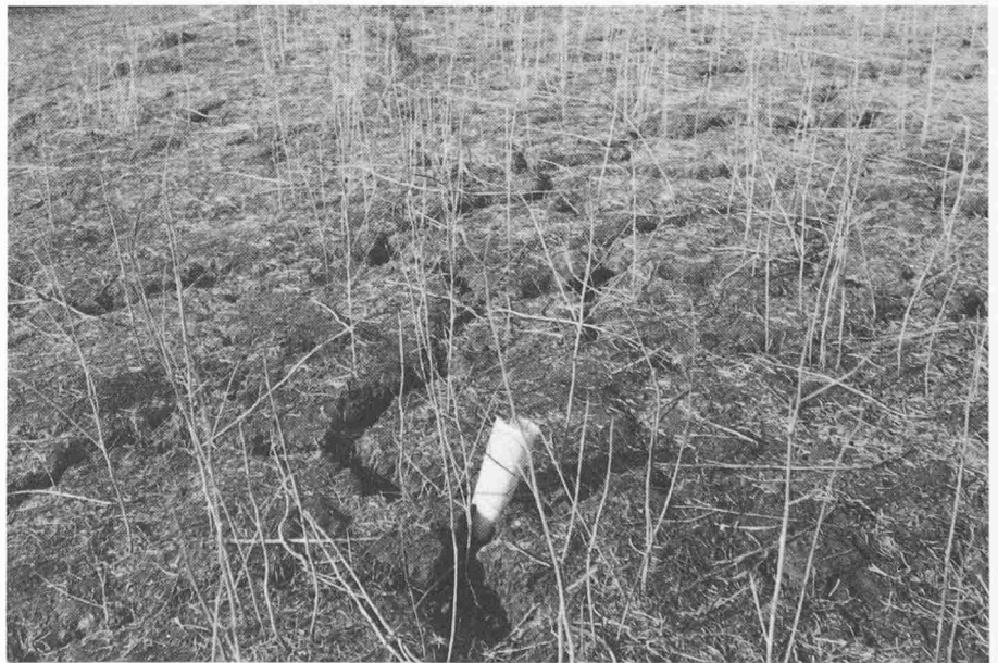
Bild 7. Schwarzer Ton mit Schrumpfrissen
