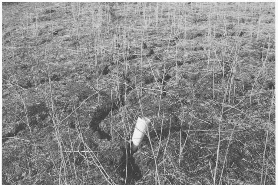
Bild 7. Schwarzer Ton mit Schrumpfrissen
