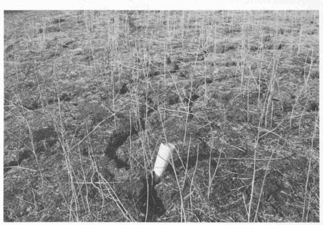
Bild 7. Schwarzer Ton mit Schrumpfrissen
