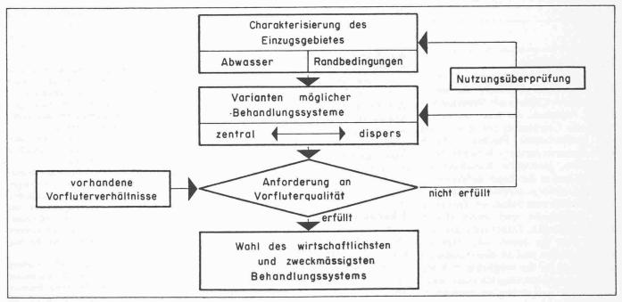
Bild 1. Vorgehensvorschlag für die abwassertechnische Sanierung in ländlichen Gebieten
